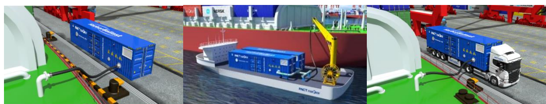
图 7-14 建立灵活的船舶“压载水”处理方式
