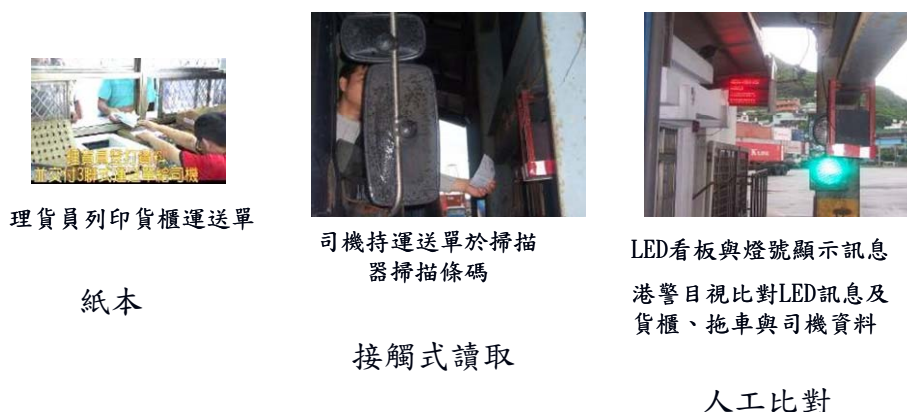
圖 2 第一代港區自動化門哨管理系統作業方式示意圖
