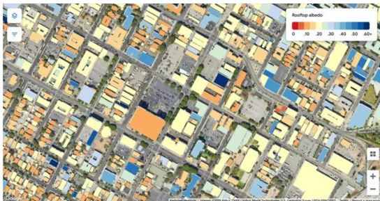
Cool Roofs 工具使用AI和航拍影像來產生高解析度屋頂太陽反射率測量結果
