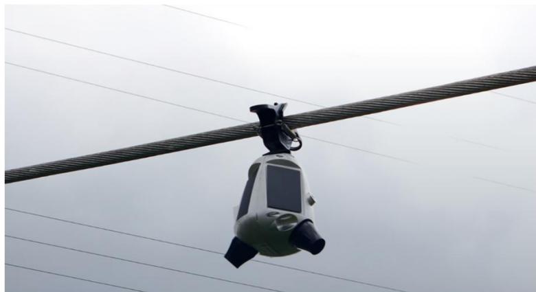
高壓電線的感測器SENTRI 提供4G/Wi-Fi到衛星的網路連接功能
